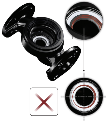
Falsch zentriertes Dichtungssystem
